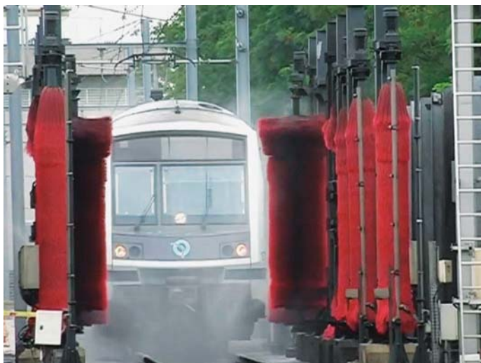
Une rame de RER en cours de lavage : on récupère l'eau de pluie sur le site des Joncherolles, dans la Seine-Saint-Denis.
